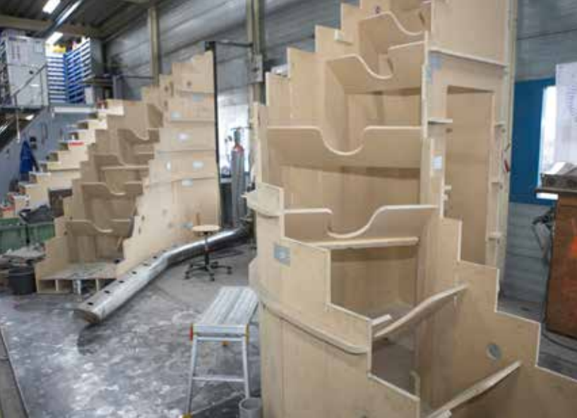
COMPLICERENDE FACTOR: TRAPPEN MET WELVINGEN. DE MOCKUPS HELPEN ALLES EXACT OP DE JUISTE PLAATS TE KRIJGEN.
