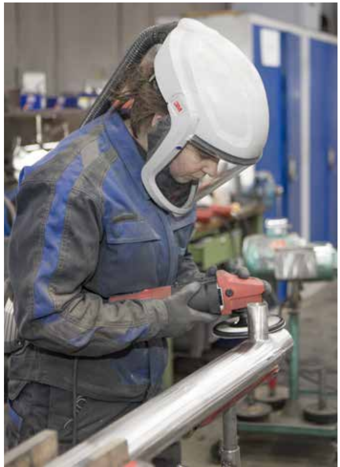
POLIJSTEN VERGT VEEL VAKMANSCHAP. WAT BIJ HET RVS-WERK OPVALT IS DAT ER GEEN LASNADEN TE ZIEN ZIJN, DIE WORDEN WEGGESLEPEN EN LANGDURIG GEPOLIJST. EERST WORDT EEN GROOT AANTAL SCHUURSCHIJVEN IN STEEDS FIJNERE GRADATIES GEBRUIKT, WAARNA WORDT OVERGESCHAKELD OP POLIJSTEN MET PASTA, WAARDOOR DE GLANS ONTSTAAT.
